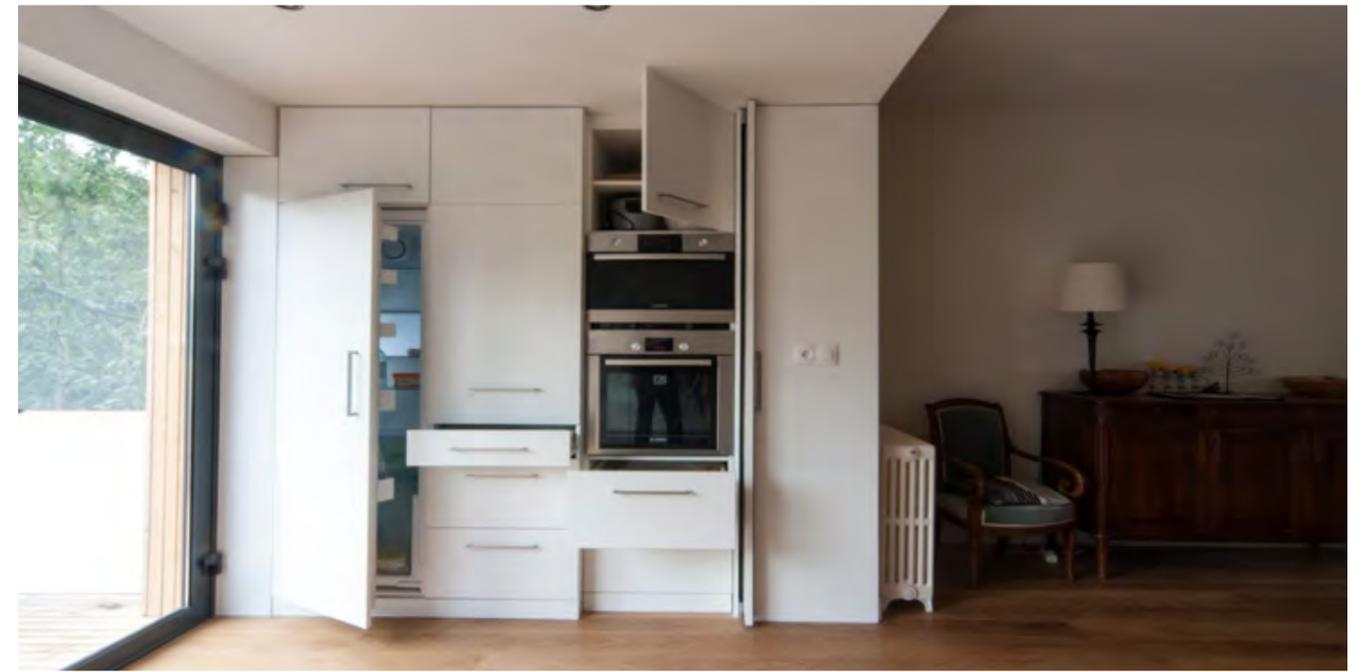
L'électroménager et les plans de travail sont réintégrés le long des murs mitoyens dans l'épaisseur des murs de refend
